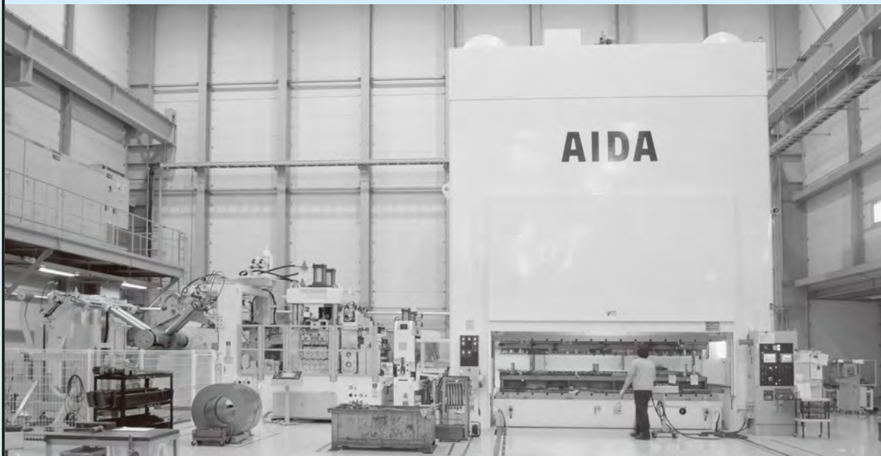
▲ PMX-L2-1600トンリンクモーションプレス(ボルスター4500×1800、400mmストローク)+レバラーフィーダ板幅1300mm 板厚4.5mm
