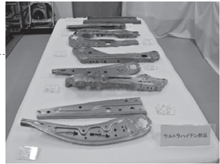
左/国内最大級の1,600t順送プレス。レベラーフィーダも特別仕様でウルトラハイテンに対応 右/同社の金型で製作したウルトラハイテン材による製品例
