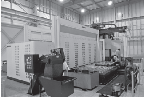
大型5面加工門型マシニング センター。パレットチェンジャー を装着し、24時間稼働
