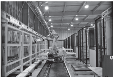
上/マシニングセンタ・ロボットセル生産システム（ライン側）。365日24時間稼働を目指す
