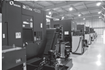
上/マシニングセンタ・ロボットセル生産システム（ライン側）。365日24時間稼働を目指す
