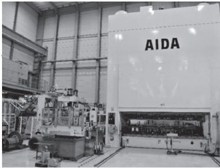
左/国内最大級の1,600t順送プレス。レベラーフィーダも特別仕様でウルトラハイテンに対応 右/同社の金型で製作したウルトラハイテン材による製品例
